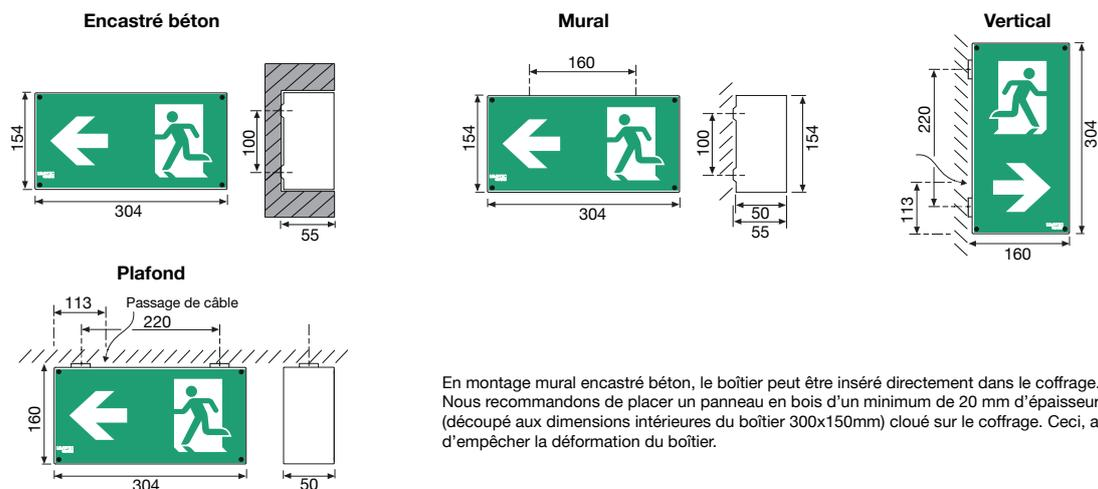
En montage mural encastré béton, le boîtier peut être inséré directement dans le coffrage. Nous recommandons de placer un panneau en bois d'un minimum de 20 mm d'épaisseur (découpé aux dimensions intérieures du boîtier 300x150mm) cloué sur le coffrage. Ceci, afin d'empêcher la déformation du boîtier.
