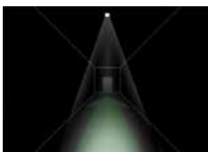
Fluchtwegausleuchtung mit asymmetrischer Optik
