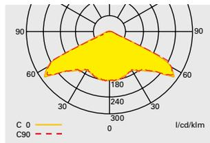
**Aide à la planification de projet pour GuideLed SL CG-S avec optique symétrique avec E = 1,0 lx (0,5 lx)**
